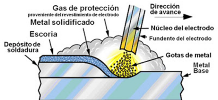
Fig 2. Proceso de Soldadura por Arco Eléctrico con electrodo Revestido
